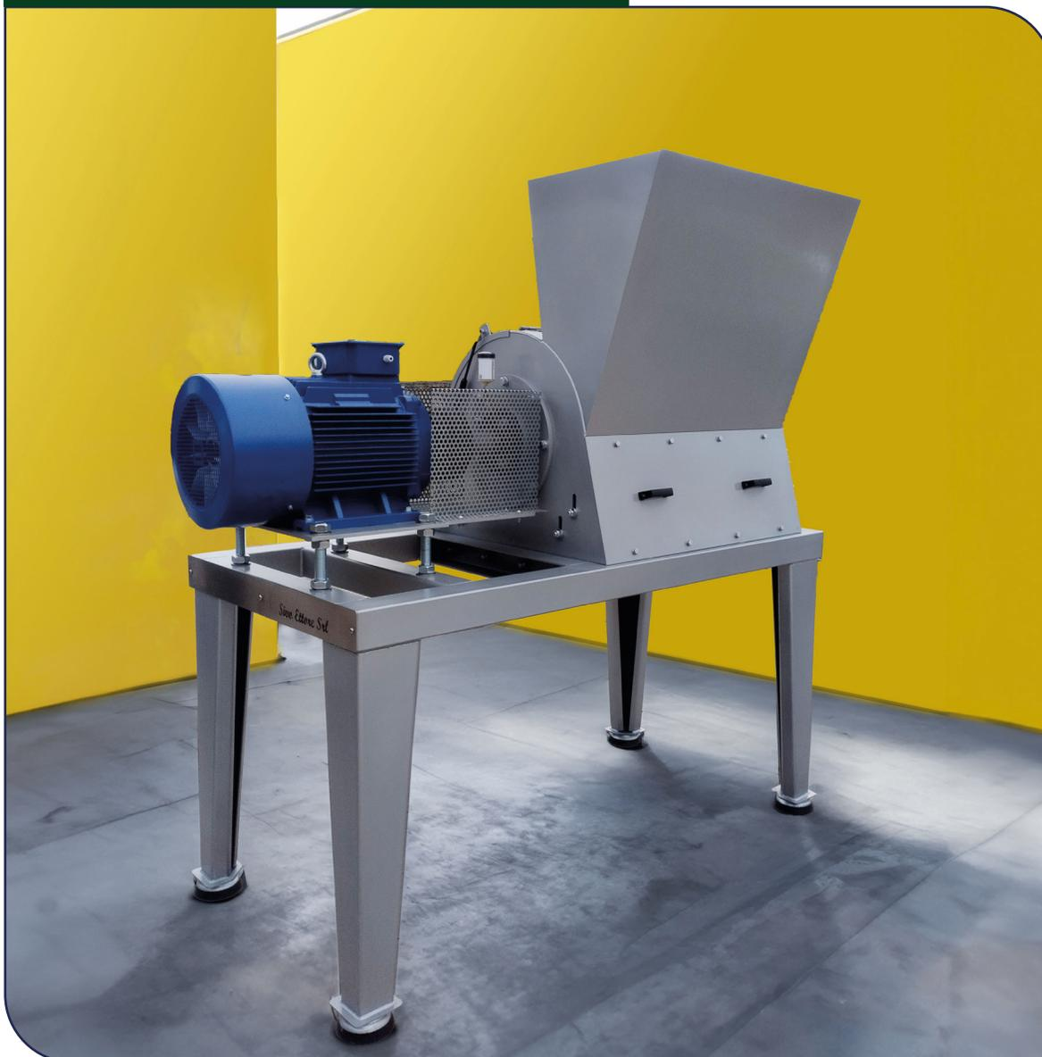
La **macchina TS50** è una macchina atta a ridurre il volume di foglie/rami fino al 70%, ed è formata da un motore elettrico direttamente accoppiato mediante un giunto in neoprene, all'asse portacoltelli della macchina, che è composto da mazze adatte alla frantumazione di sarmenti.
